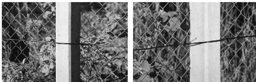
Figs. 8 y 9 – Cable sensor fijado a un poste del cerco
